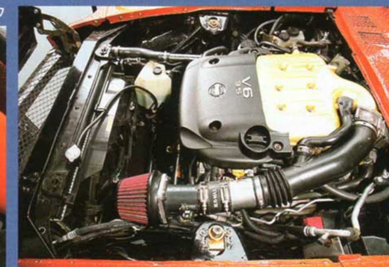
ストラットケースよりも後ろにエンジンがマウントされているのがわかる。ノーマルよりも重量配分が良さそうなのもモノ
