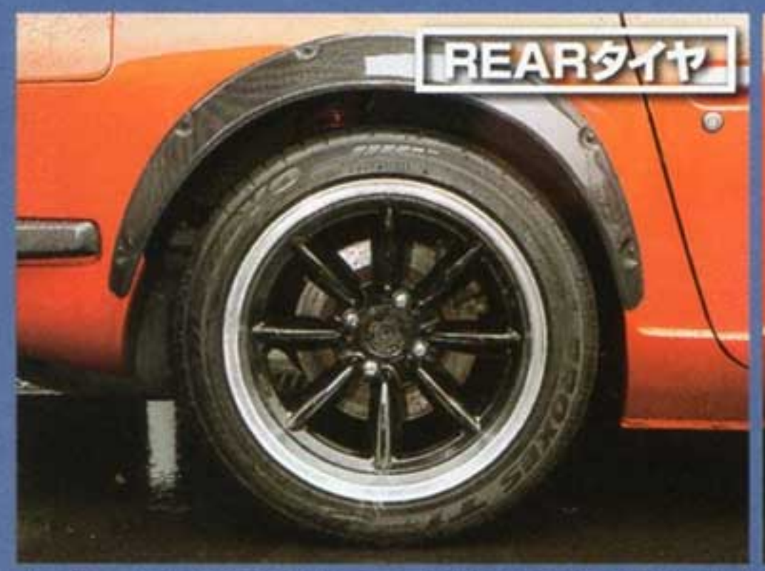
ホイールは前後17インチで前235/40、後ろ255/40のR1R。フロントブレーキはウイロッドでベルがアルミの2ピースローター、リヤもディスク化されていて駐車ブレーキももちろん備わっている
