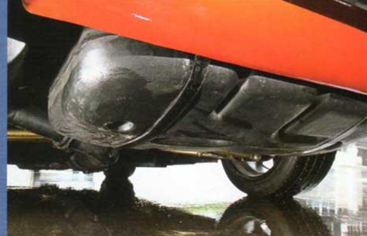
樹脂製のタンクに交換し容量を上げている。燃料ポンプはインタンク式を取り付けている
