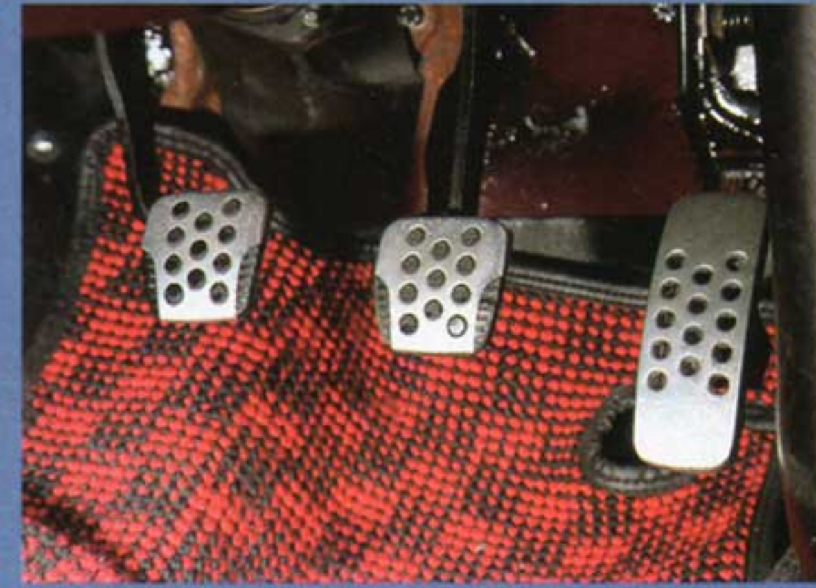
ブレーキ、クラッチ、アクセルペダルもまままZ33。配置も自然でノーマルのS30よりも扱いやすかった
