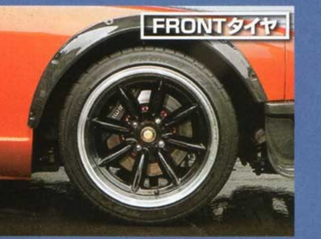
ホイールは前後17インチで前235/40、後ろ255/40のR1R。フロントブレーキはウイロッドでベルがアルミの2ピースローター、リヤもディスク化されていて駐車ブレーキももちろん備わっている
