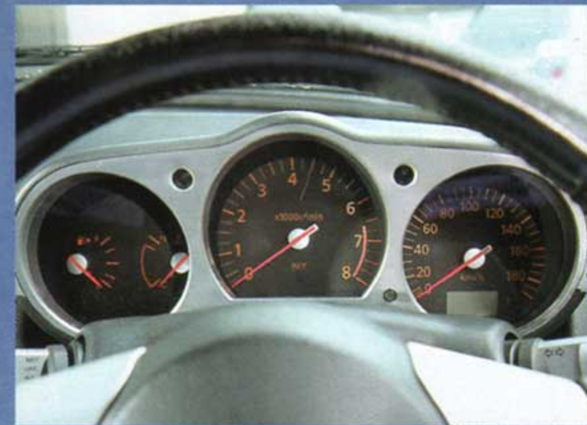
スピード&タコメーター、燃料/水温メーター周りはZ33をそのまま流用しているのZ33の見た目まま
